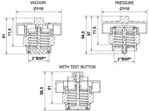
Set pressure tolerance: Max ( $\pm 3\%$ ; 0,1b/1,45 PSI)
